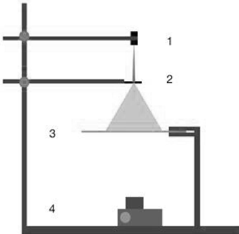
Рис.1. Схема установки для лазерной дифрактометрии мазка крови. Установка включает в себя лазер (1), мазок крови (2), экран для наблюдения дифракционной картины (3), видеокамеру (4).
