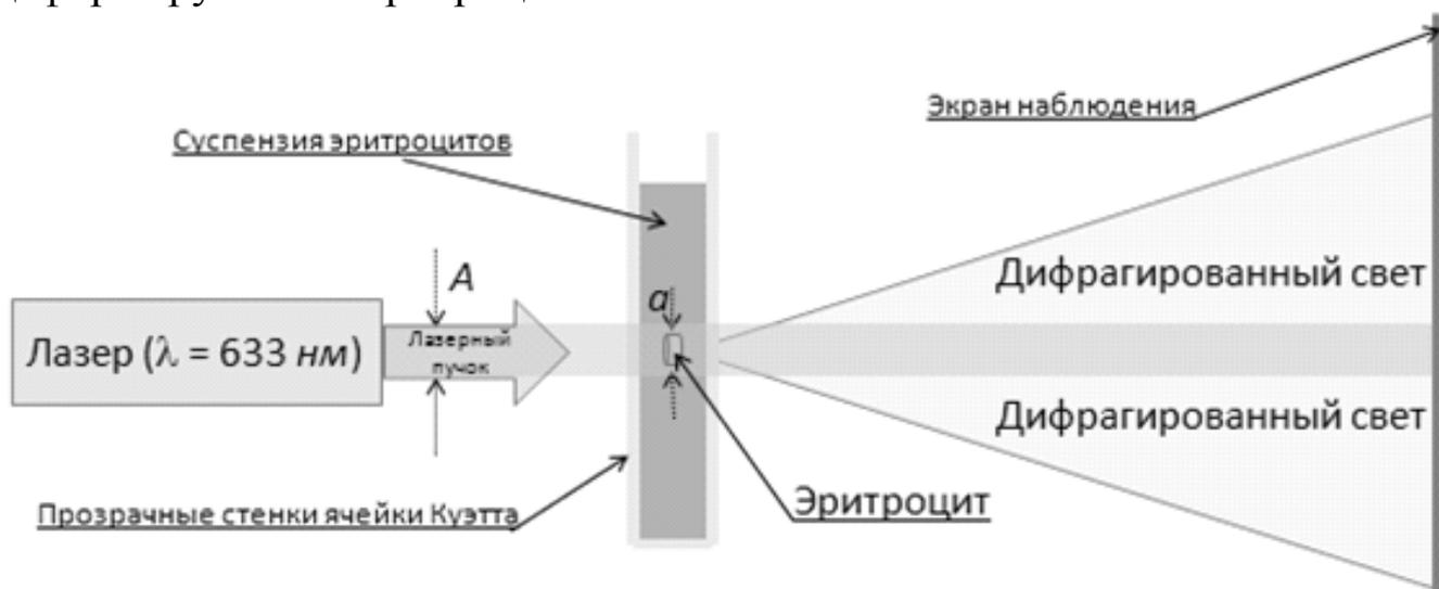
Рис.1. Схема лазерного эктацитометра эритроцитов
