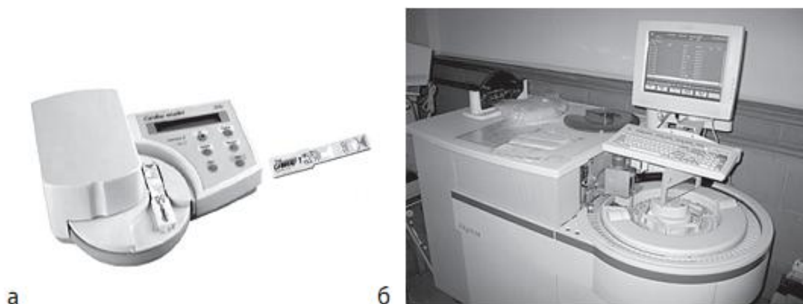
Рисунок 9. – Иммунохимические автоанализаторы для определения концентрации тропонинов в крови: а) портативный; б) стационарный
