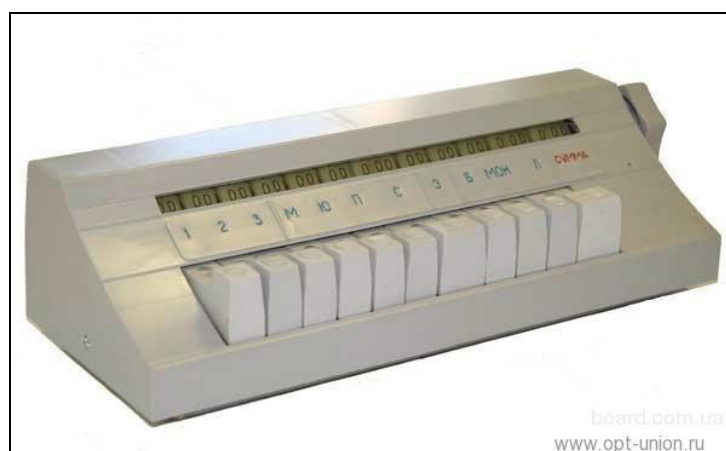
Рисунок 25. – Счетчик для подсчета лейкоцитарной формулы
